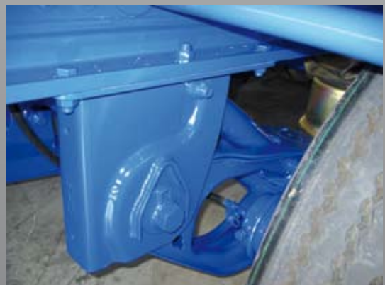
našroubovatelná podpěra náprav pro hliníkový podvozek
