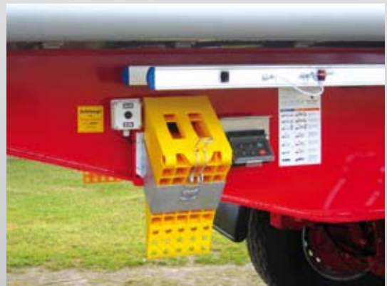
vypínač automatického snížení při sklápění, spínač pro funkce zdvihu a snížení ložné plochy
