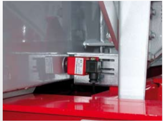
kontrolní snímač pro snížení ložné plochy při sklápění
