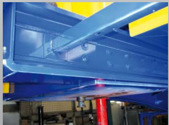
našroubovatelná ocelová točnicová deska pro hliníkový podvozek
