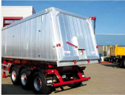
vnější výklopná stěna s výsypkou na obilí
